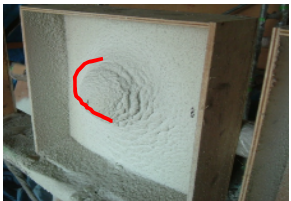
エア-吹付け工法 吹付け後の形状
